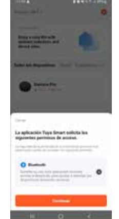
4. Una vez iniciada la sesión exitosamente, al tener el bluetooth activo, debe otorgar los permisos de acceso de bluetooth a la aplicación Tuya Smart.
