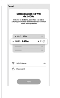
7. Para activar el modo de conectividad Wi-Fi presione los dos botones de la Aspiradora Robot simultáneamente hasta que el LED de Wi-Fi empiece a parpadear rápidamente. Seleccione una Red WiFi de 2.4 GHz introduzca la contraseña y conecte el dispositivo.
