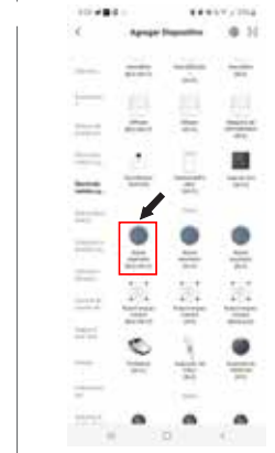
6. Entre al menú "Agregar Equipo", seleccione la opción "Electrodoméstico pequeño / Small Home Appliance", posteriormente agregue la opción "Robot Aspirador" (BE+WiFi). Con esta opción, si pierde la conexión a internet, le será posible utilizar su Aspiradora Robot por medio de Tuya Smart con la conexión a Bluetooth.
