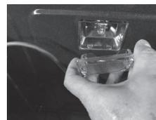
3.2.- Reemplace el bulbo de halógeno por uno nuevo del tipo G9 de 40 Watts a 120 Volts para electrodomésticos.
