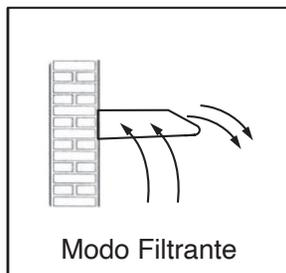
**Modo Filtrante.** Con la malla retirada, únicamente coloque la palanca en la posición como se muestra en el dibujo.
