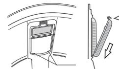
Coloque la cubierta del filtro en las dos rendijas y presione cuidadosamente como se muestra en la imagen
