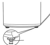
Las patas son ajustables (se extienden al girar a la derecha y se acortan al girar a la izquierda). Incline ligeramente la lavadora primero y afloje la perilla de las patas ajustables. Ajuste las patas para asegurarse de que las cuatro esquinas de la lavadora estén sobre el piso. Luego ajuste las perillas de las patas ajustables y asegúrelas. Si el piso no es plano, deberá corregir la superficie, caso contrario la cesta se inclinará y se golpeará con la lavadora.
